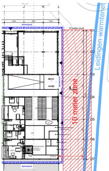
Figuur 3 Bouwkuip Vlaardingenlaan 11 en globale ligging leidingen Vattenfall [3]
