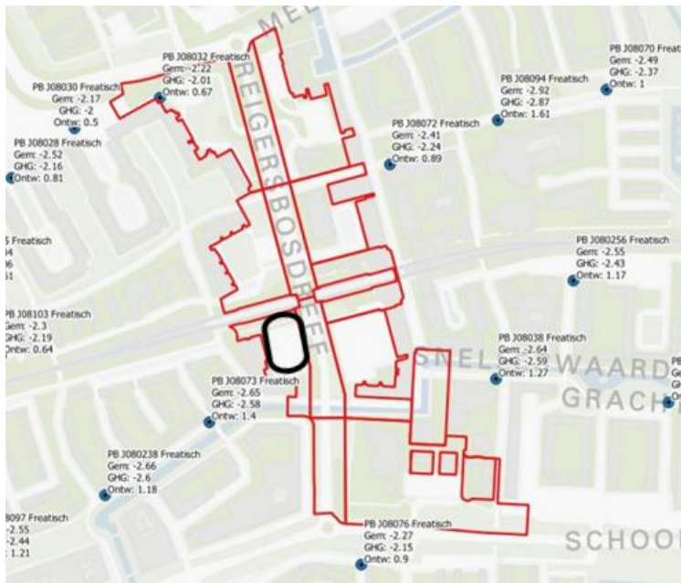
Freatische peilbuizen Waternet met gemiddelde grondwaterstand en GHG (m + NAP) en ontwatering (bron: Grondwatertoets Reigersbos).
