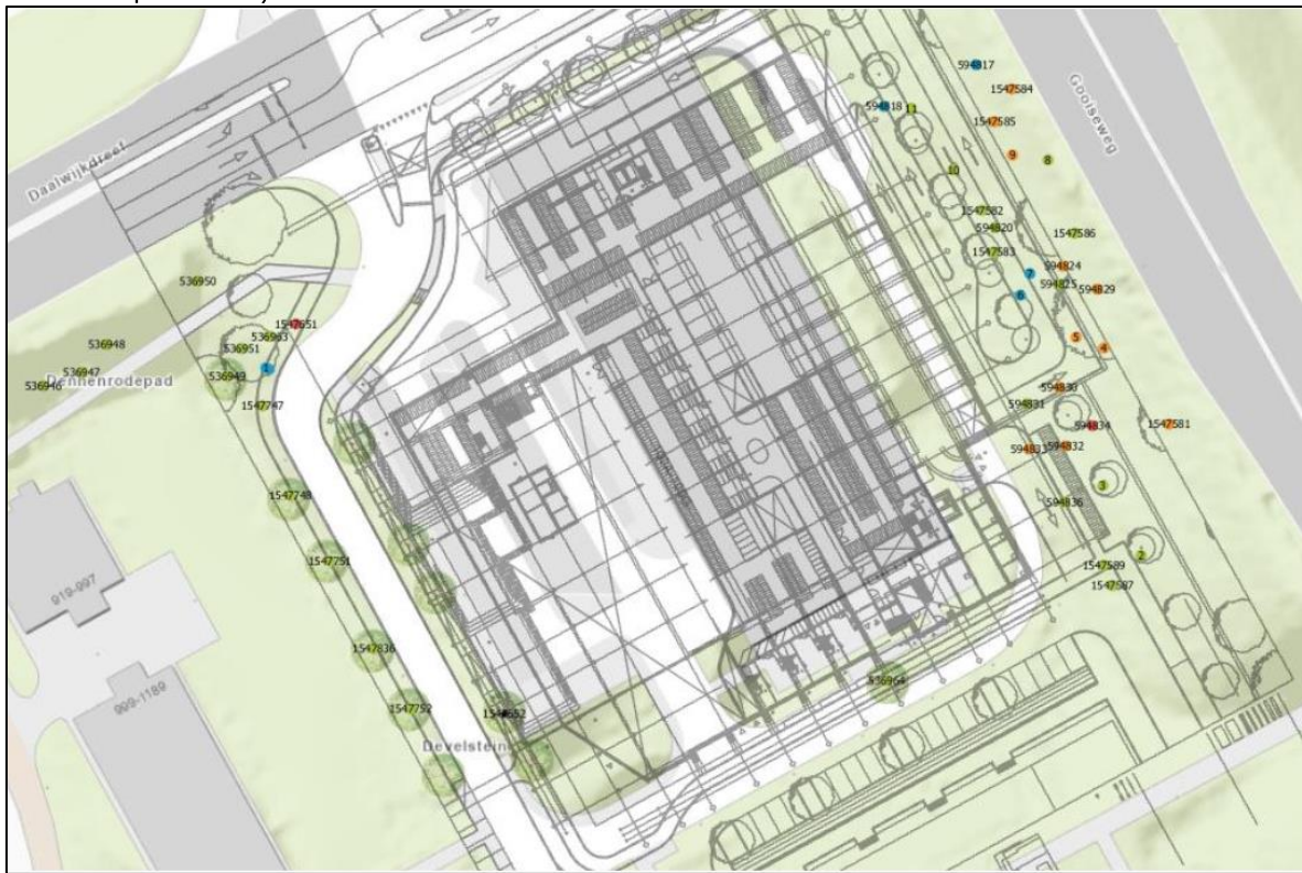
Figuur 15. Gebied langs Goiseweg met aantallen te kappen bomen op basis van het plan (bron: Boom Effect Analyse Copijn Boomspecialisten)
