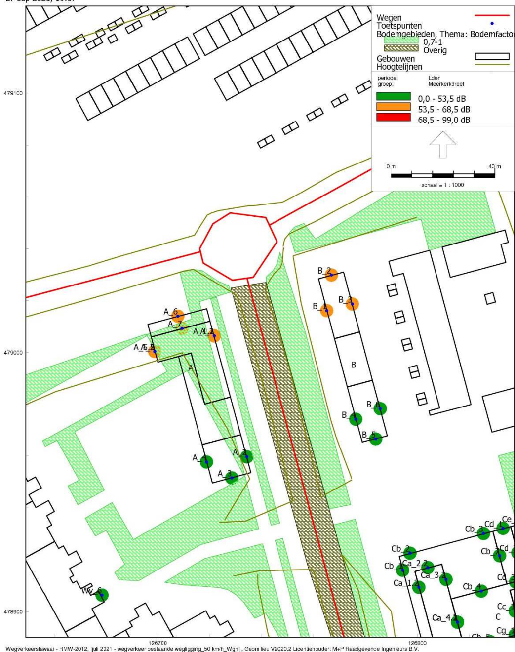
figuur 8 Toets met kleurcode voor maximale geluidsbelasting per wnp Meerkerkdreef
