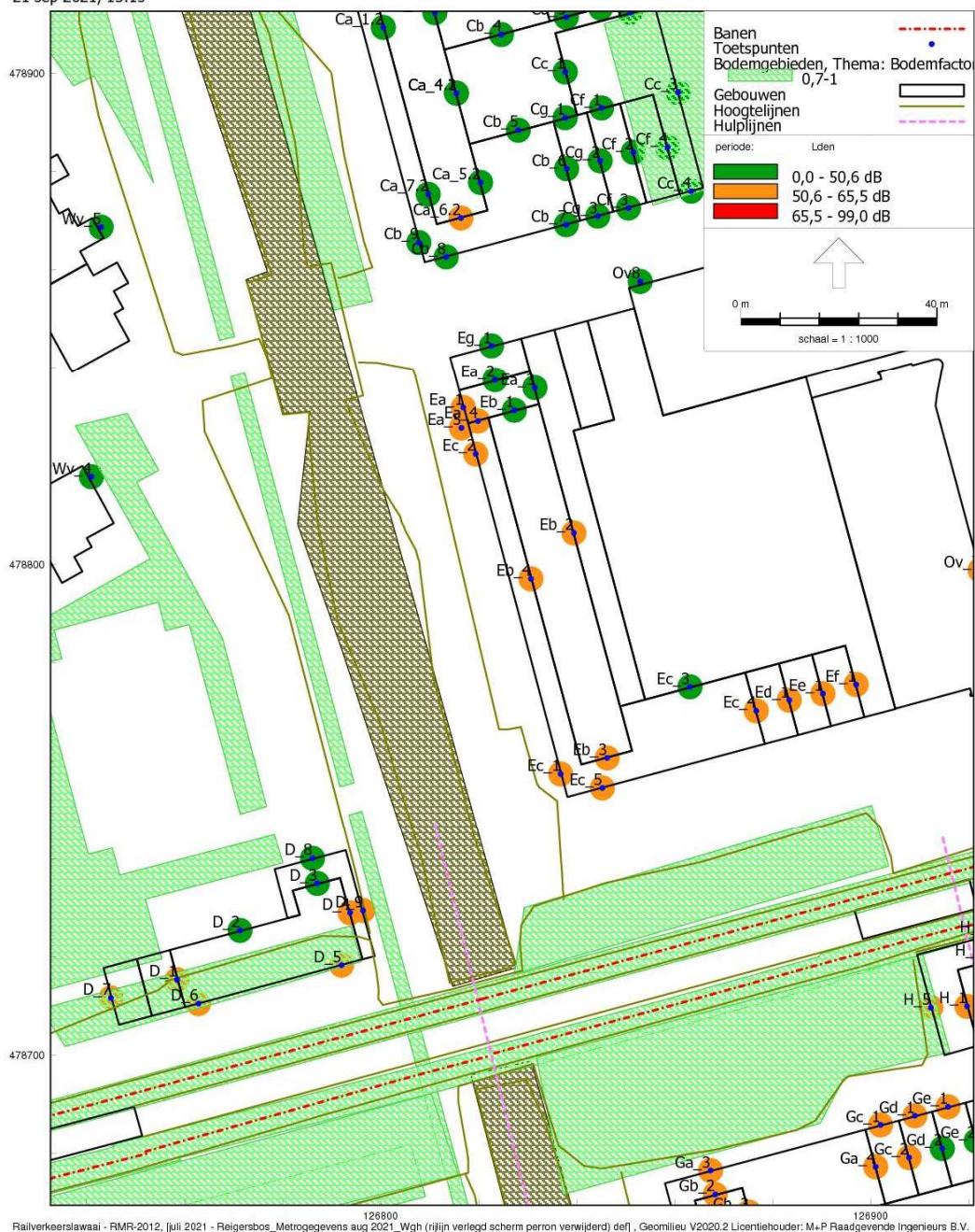
figuur 6 Toets met kleurcode voor maximale geluidsbelasting per wnp Metrolijn noord excl. maatregelen
