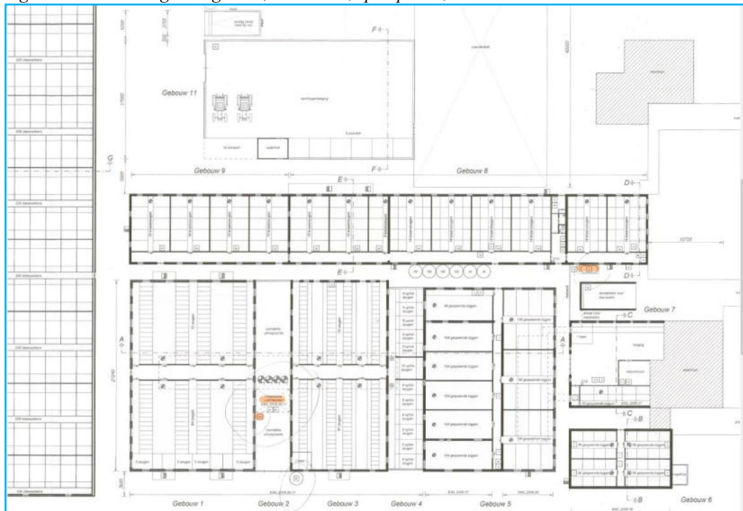
Figuur 10: milieuvergunning 2010, dieseltank, spoelplaats, luchtwasser en zuurtank
