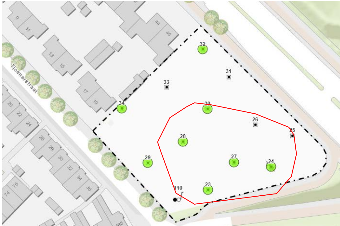
Figuur 5.1 Resultaten analyses bovengrond (0 - 0,6 m -mv). Groen is kleiner dan achtergrondwaarde. Met rood is de globale ligging van de stort weergegeven.
