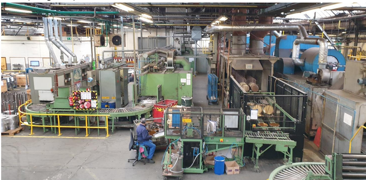
Figuur 36 Rechts uitgang van de Wicket oven waarin de lak op de bodem en deksels wordt uitgehard
