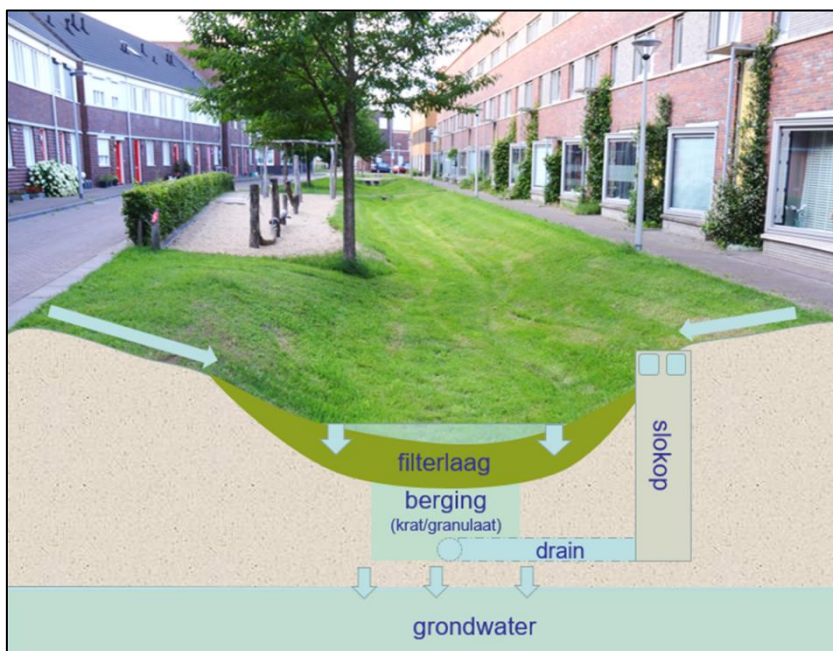
Figuur 13: Dwarsdoorsnede van een wadi. Bron: Kennisportaal Klimaatadaptatie.
