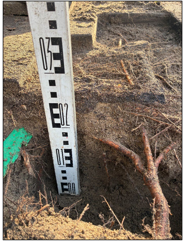
Figuur 19: Zicht op profielsleuf ter hoogte van boom 109 met sterke wortelontwikkeling onder de tegelverharding.
