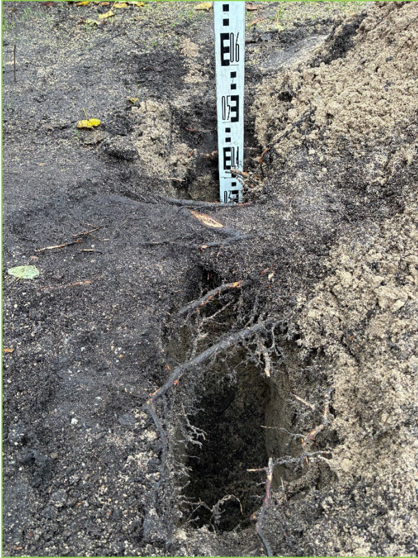
Figuur F: Sterke wortelontwikkeling in halfverharding nabij boom 93.
