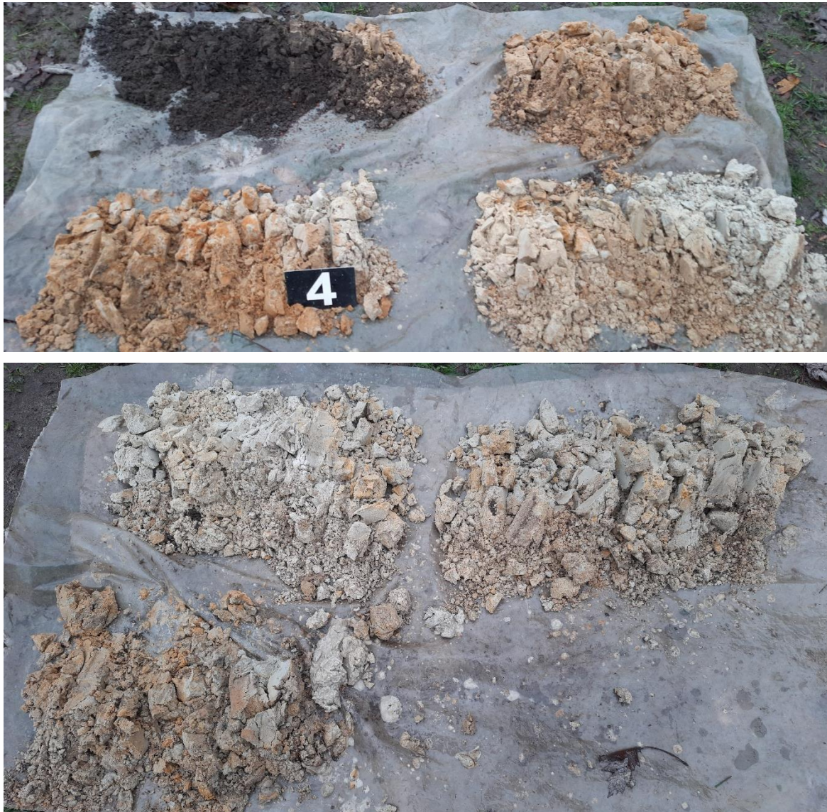
Abbeelding 6: Foto profielboring uitgelegd per meter vanaf maaiveld (linksboven) tot einddiepte (onder).
