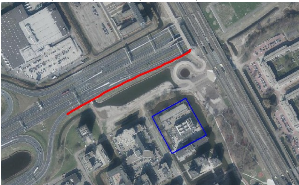
f5.3 Onderzochte maatregel – scherm langs A9 (8 meter hoog en ca. 350 meter lang)
