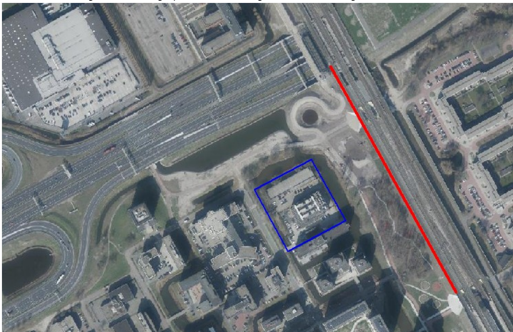
f5.4 Onderzochte maatregel – scherm langs spoor (3,5 meter hoog en ca. 400 meter lang)
