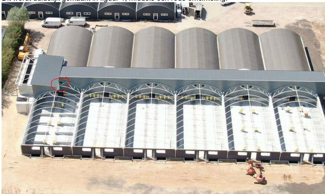
Figuur 1. Plaats meet/smoorunits per afdeling met specifieke aanduiding bij de voorste afdeling.
