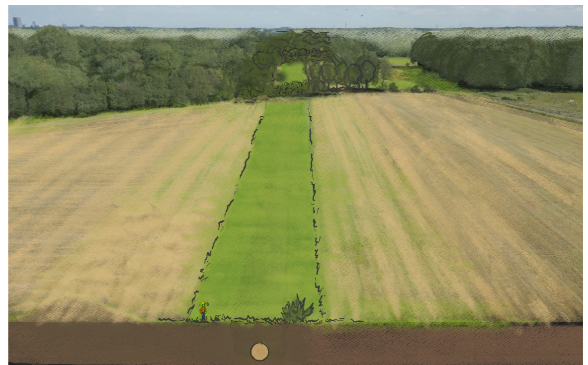
Situatie na herstel. Vanaf het riool blijft een strook van 15 m vrij van (hoge) bomen. Bomen en struweel worden teruggeplant.
