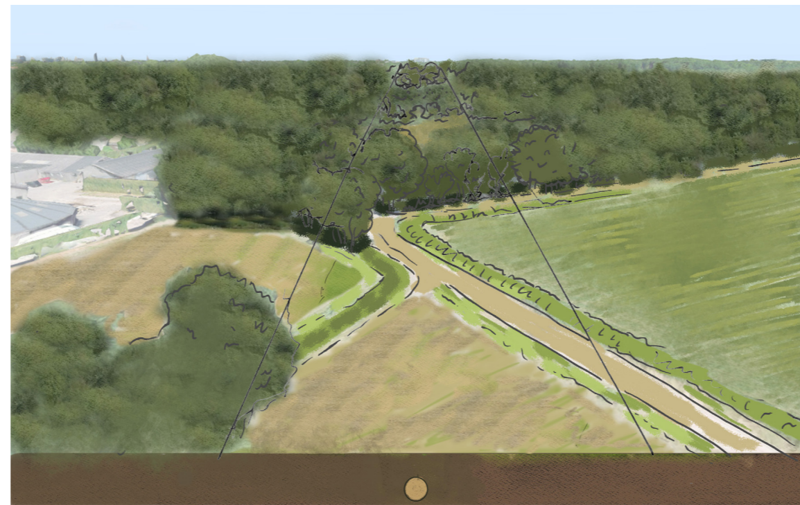
Situatie na herstel. Vanaf het riool blijft een strook van 15 m vrij van (hoge) bomen. Bomen en struweel worden teruggeplant.
