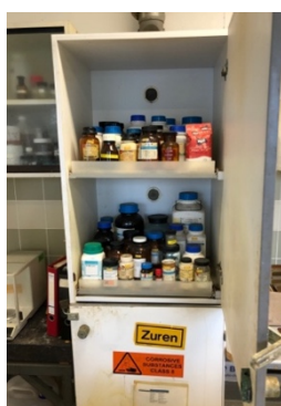
Figuur 15. Laboratorium (V). Opslagkast voor zuren en basen (links) en opslagkast onder de zuurkast zonder opvangbak (rechts).
