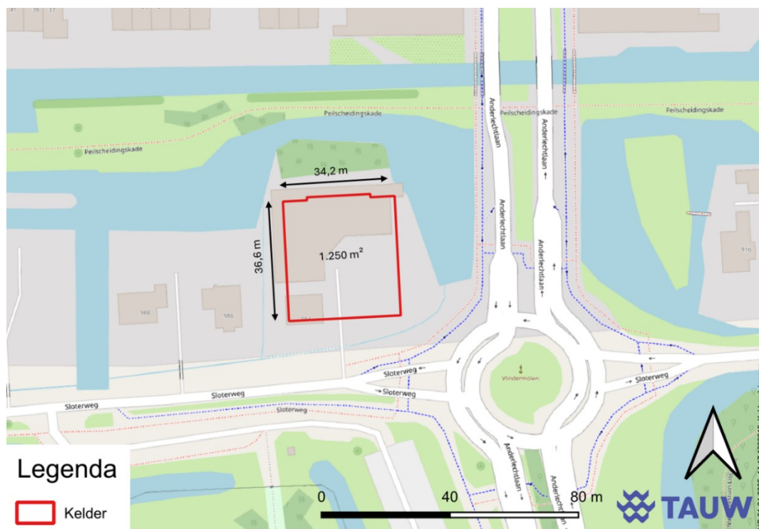
Figuur 3.1 Overzicht afmetingen kelder, gebaseerd op de door de opdrachtgever aangeleverde technische tekening
