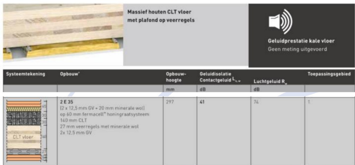
Figuur 3: vergelijkbare opbouw Fermacell constructies versie december 2019
