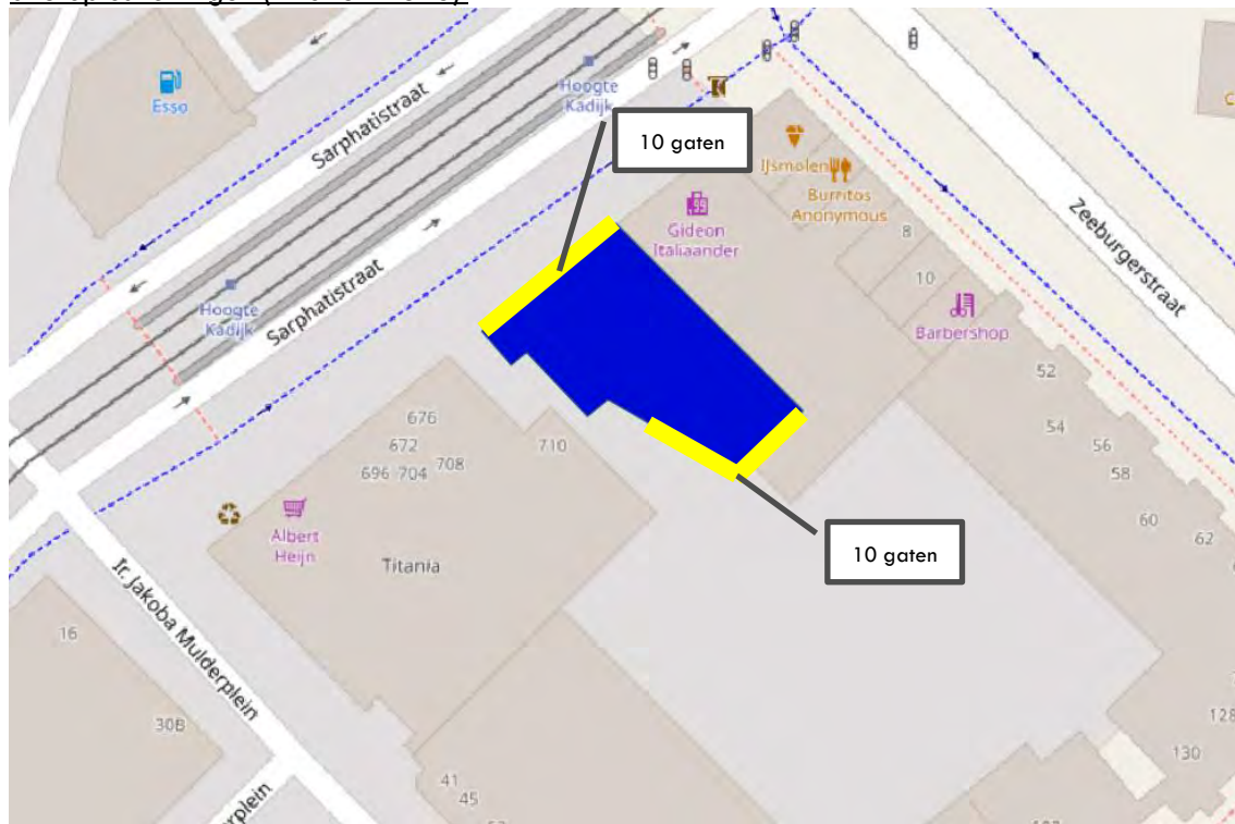
Figuur 12 – kelder is grondwaterneutraal bij toepassen maatregelen langs gevels welke geel zijn (voor alle oplosrichtingen).
