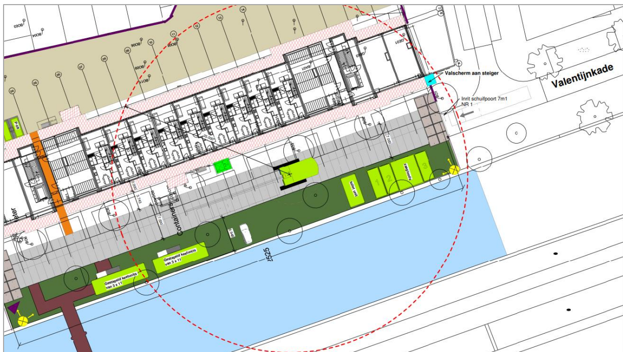
Afbeelding 2.2: bouwplaatstekening voor de werkzaamheden Valentijnkade. De lichtgroene vlakken geven de geplande locaties voor de gestapelde keetunits weer 2 .
