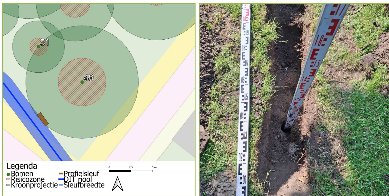
Figuur 39: ligging riooltracé ten opzichte van boom 49; resultaat profielsleuf.
