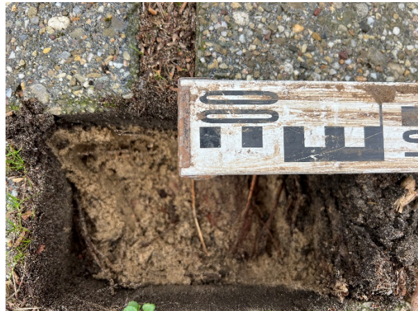
Afbeelding 9. Oppervlakkige wortel doorsnede ca < 10cm onder verharding.
