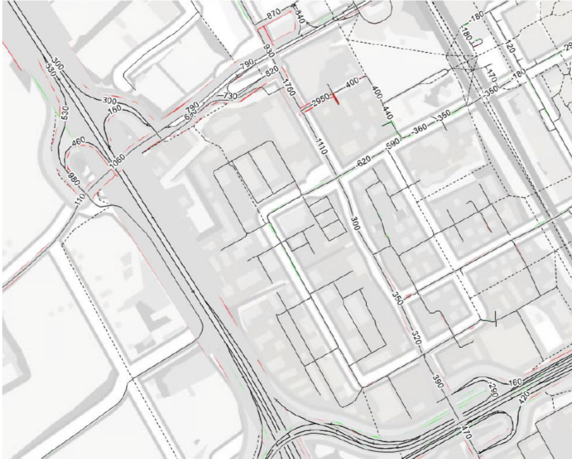
Figuur 6. Verschilplot tussen 2040 Autonoom en 2040 Plan (motorvoertuigen per etmaal), rood is toename, groen is afname.
