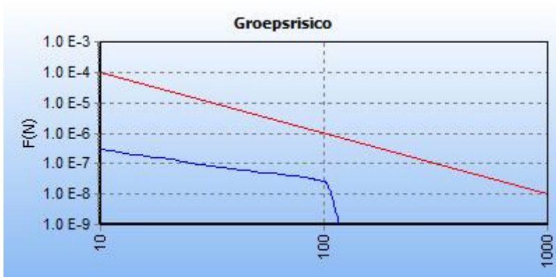
5.2 Figuur 5.2 FN curve voor 9489_leiding-W-534-01-deel-1 van N.V. Nederlandse Gasunie voor de kilometer tussen stationing 1710.00 en stationing 2710.00
