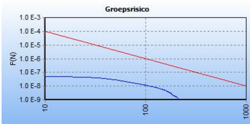
5.2 Figuur 5.2 FN curve voor 9489_leiding-W-534-01-deel-1 van N.V. Nederlandse Gasunie voor de kilometer tussen stationing 1710.00 en stationing 2710.00
