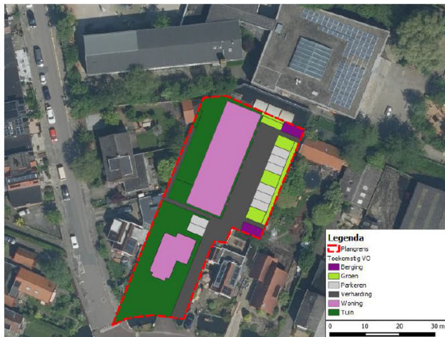
Figuur 2-2: Overzicht oppervlakken nieuwe situatie
