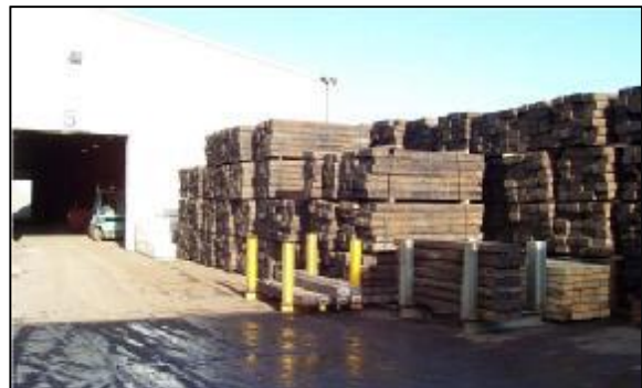
Figuur 4: Opslag van spoorbielzen voor hergebruik
