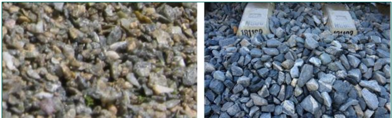
Figuur 20: Verschil kiezels (links) en breuksteen (rechts) (Bron: REASeuro-database).
