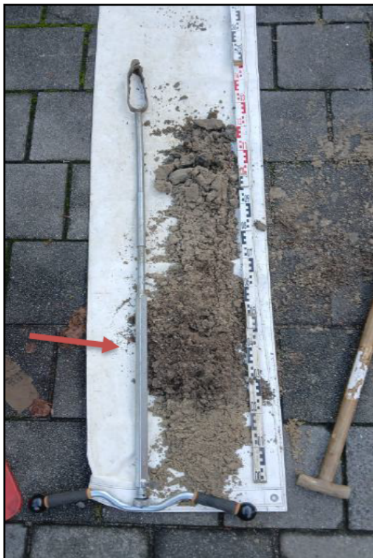
Foto 7: Impressie van profielboring D waarbij matig humusarm zand alleen is gevonden tussen de 20 en 50 cm, aangewezen met rode pijl.
