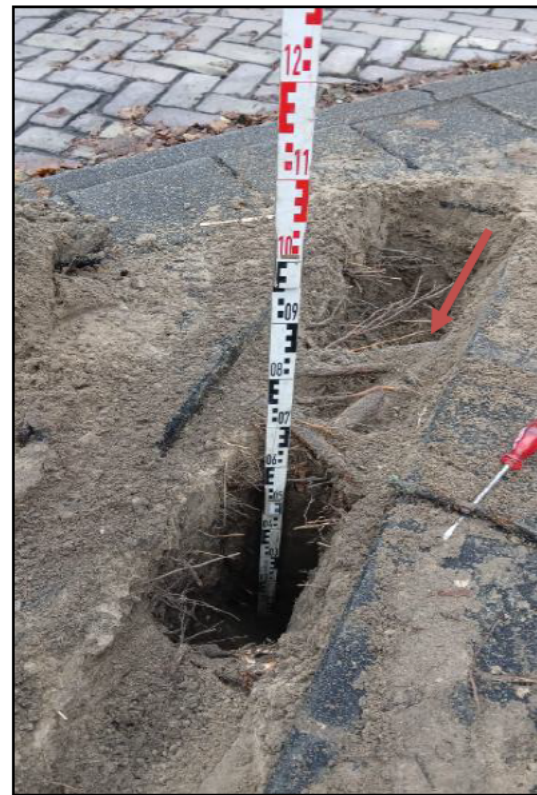
Foto 8: Impressie van proefsleuf E, waarbij zeer oppervlakkig beworteling zichtbaar is tot 5cm dik aangewezen met rode pijl.
