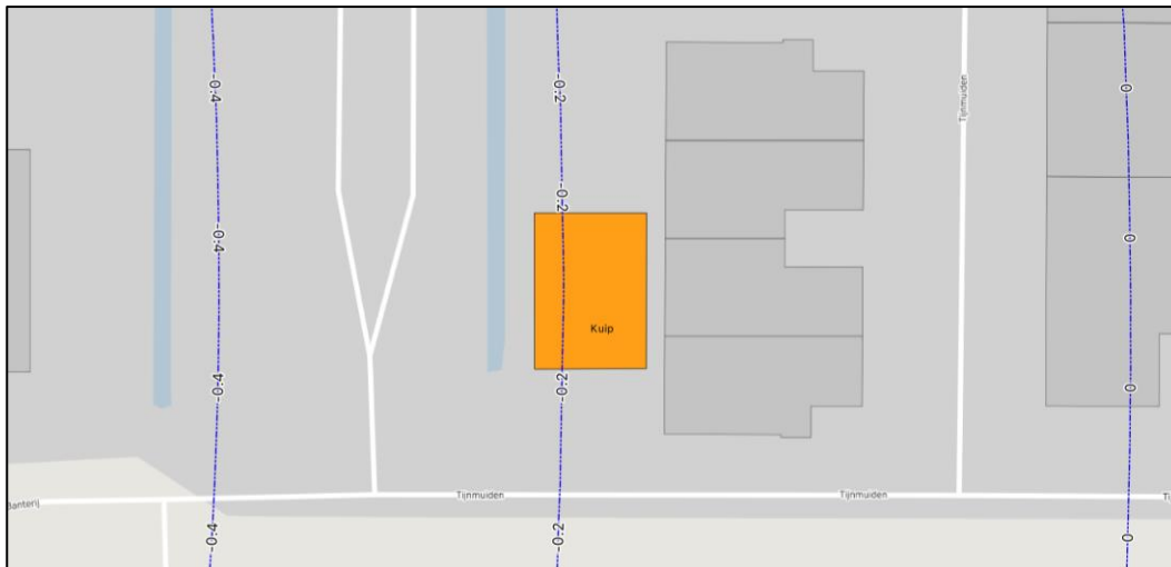
Afbeelding 6 – Isohypsen (blauwe lijnen) in de situatie zonder de toekomstige kelder (oranje vak) en het ontbreken van afwatering door de westelijk gelegen watergang, weergegeven in [mNAP] o.b.v. metingen.
