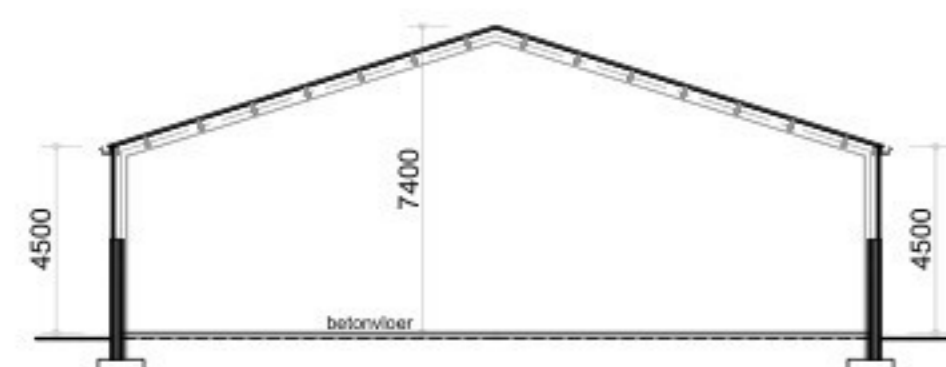
- Doorsnede A - A gebouw 2 -
