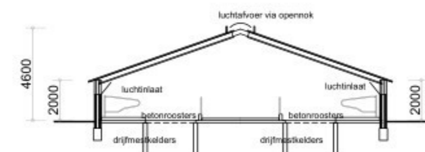
- Doorsnede B - B gebouw 3 -
