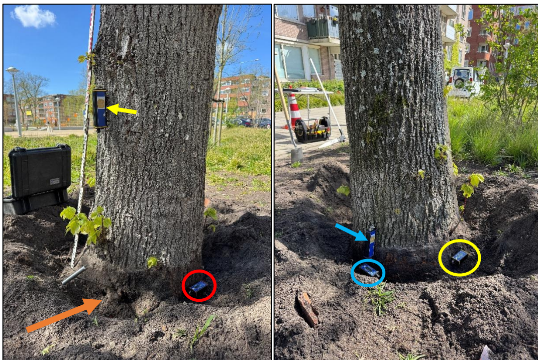
Foto 2 en 3: Links en rechts een foto van de stamvoet met de sensorplaatsing. De oranje pijl geeft de locatie van houtrot in de stamvoet aan. De inclinometers zijn met cirkels weergegeven en de elastometers zijn met pijlen aangeduid. De kleur correspondeert met de kleurcodering in tabel 2.
