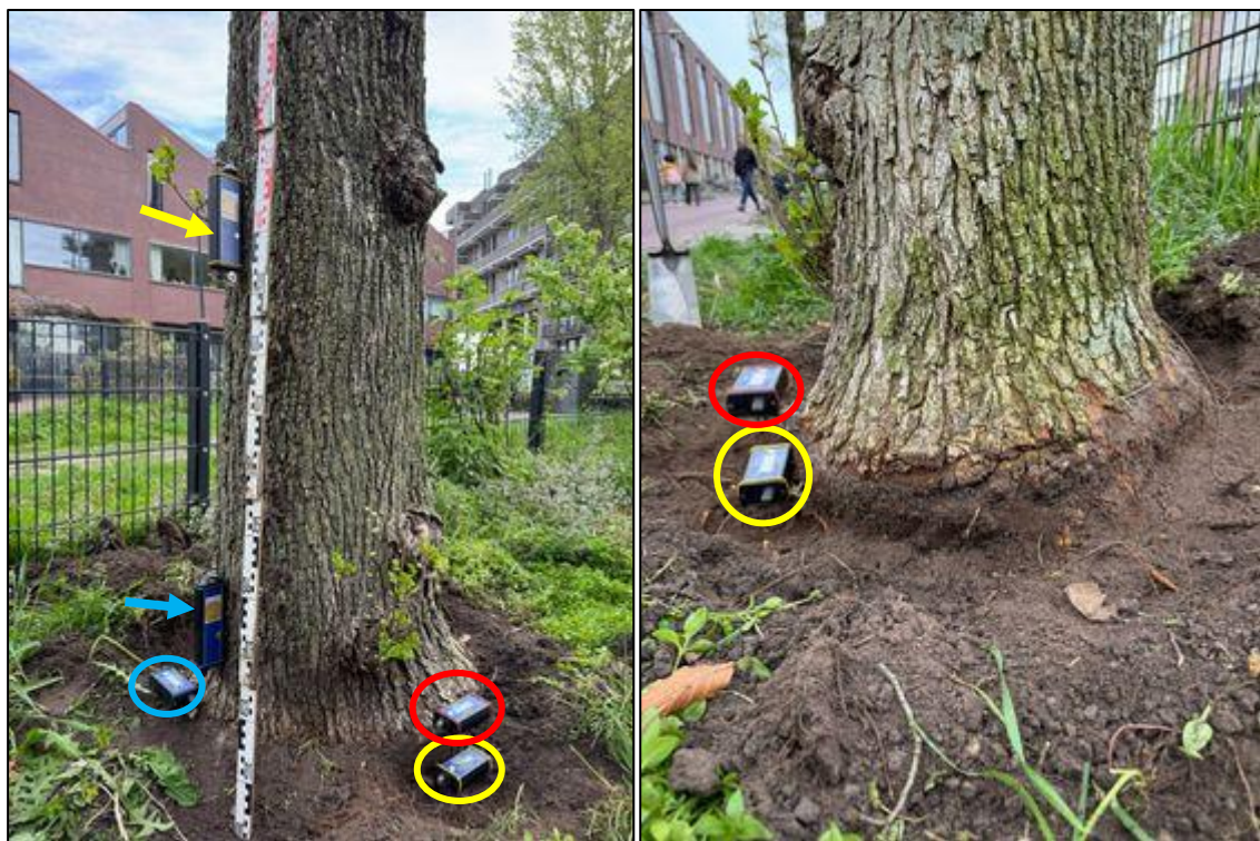
Foto 8 en 9: Links en rechts een foto van de stamvoet met de sensorplaatsing. De inclinometers zijn met cirkels weergegeven en de elastometers zijn met pijlen aangeduid. De kleur correspondeert met de kleurcodering in tabel 6.
