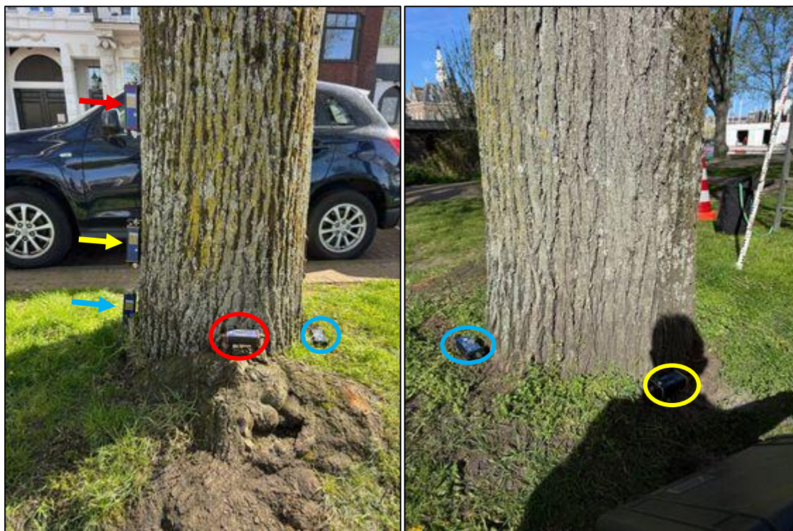
Foto 14 en 15: Links en rechts een foto van de stamvoet met de sensorplaatsing. De inclinometers zijn met cirkels weergegeven en de elastometers zijn met pijlen aangeduid. De kleur correspondeert met de kleurcodering in tabel 10.
