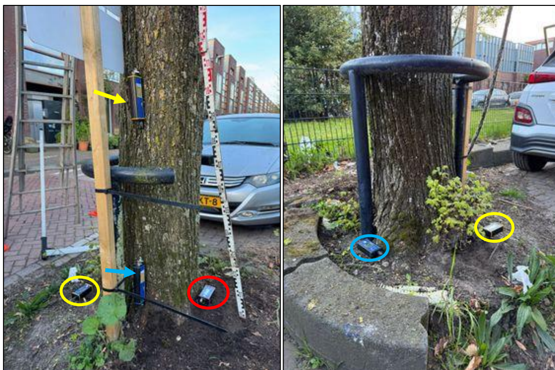
Foto 11 en 12: Links en rechts een foto van de stamvoet met de sensorplaatting. De inclinometers zijn met cirkels weergegeven en de elastometers zijn met pijlen aangeduid. De kleur correspondeert met de kleurcodering in tabel 8.
