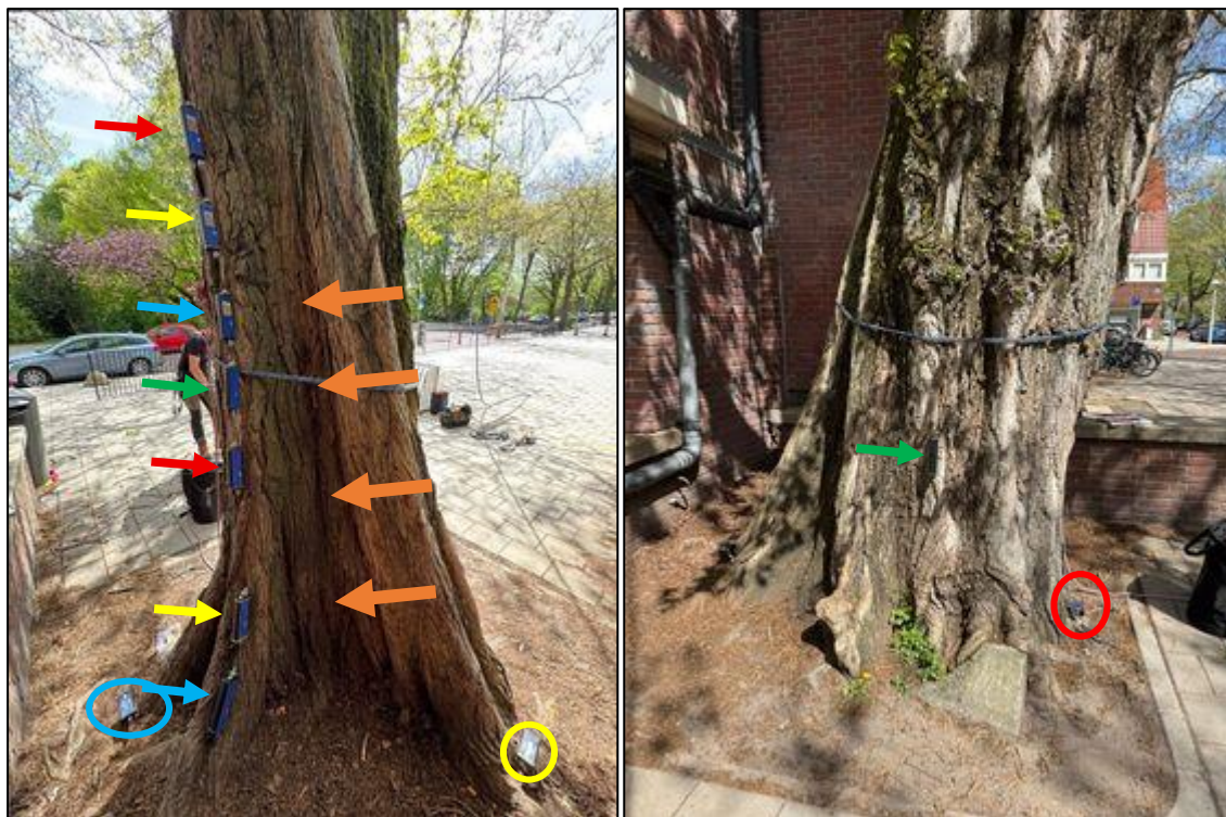
Foto 20 en 21: Links en rechts een foto van de stamvoet met de sensorplaatsing. De locatie van de oranje pijlen geeft de locatie van rotting aan. De inclinometers zijn met cirkels weergegeven en de elastometers zijn met pijlen aangeduid. De kleur correspondeert met de kleurcodering in tabel 14.
