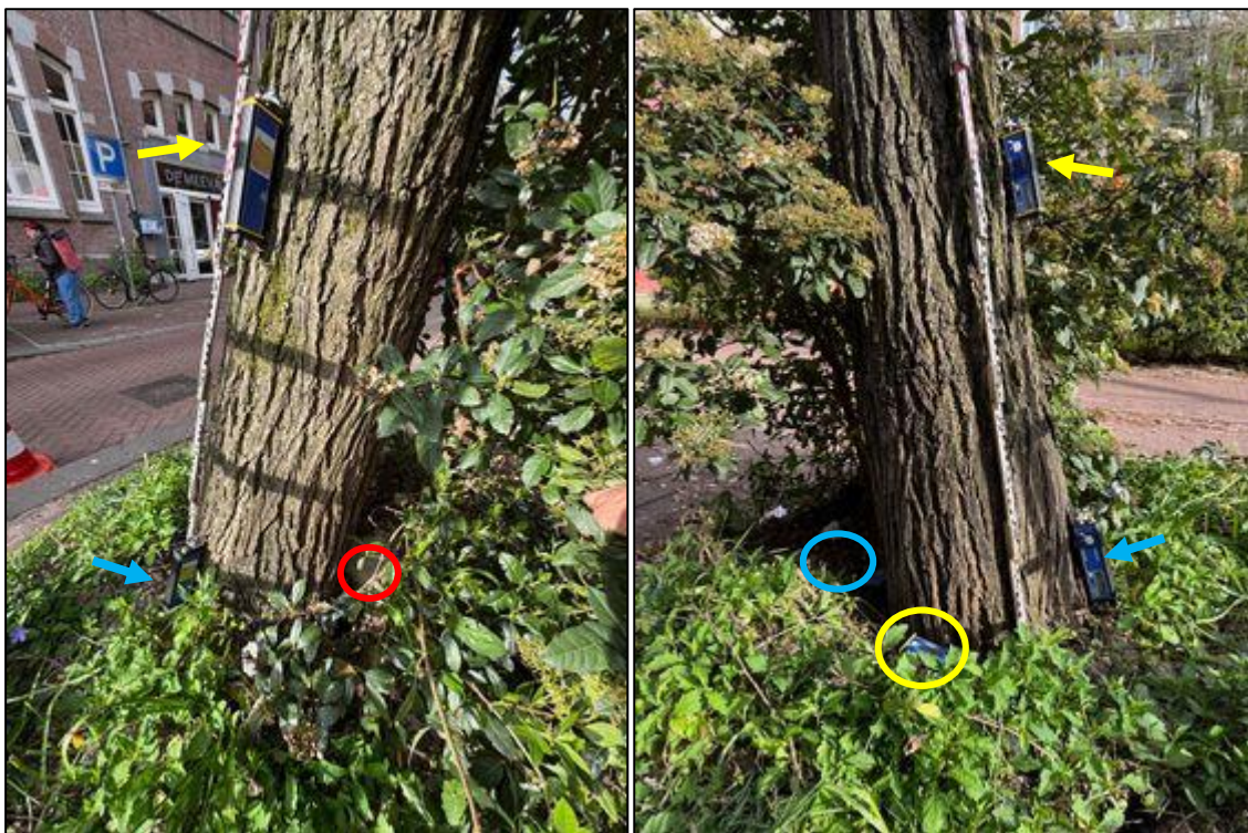
Foto 5 en 6: Links en rechts een foto van de stamvoet met de sensorplaatsing. De inclinometers zijn met cirkels weergegeven en de elastometers zijn met pijlen aangeduid. De kleur correspondeert met de kleurcodering in tabel 4.
