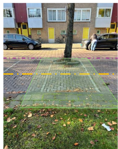
Afbeelding 28. Paars, globale ligging laagspanning, oranje globale ligging lage druk gasleiding. Groen contouren asymmetrische verplantkult.
