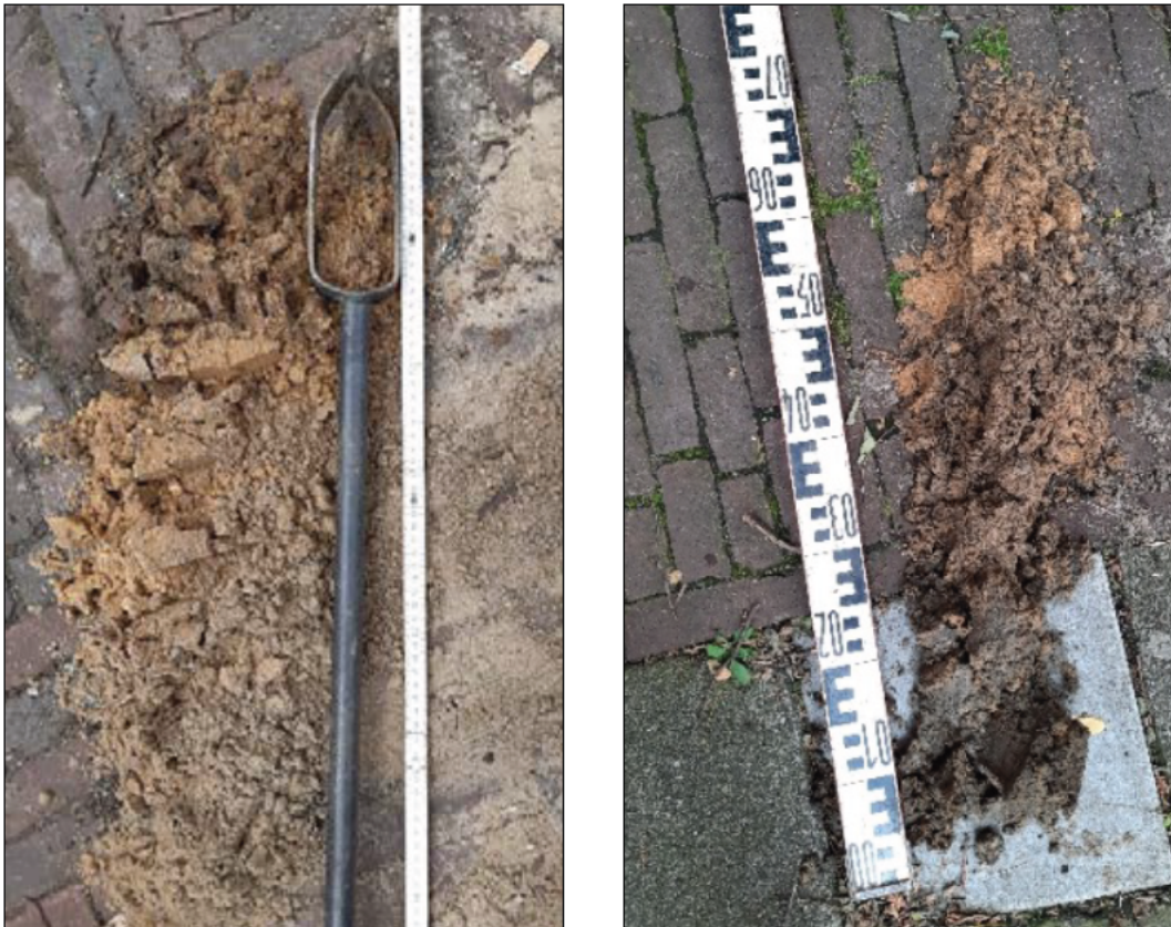
Afbeelding 1 en 2: Links de algemene bodemopbouw onder verharding. Rechts de bodemopbouw naast een boom met bomenzand.
