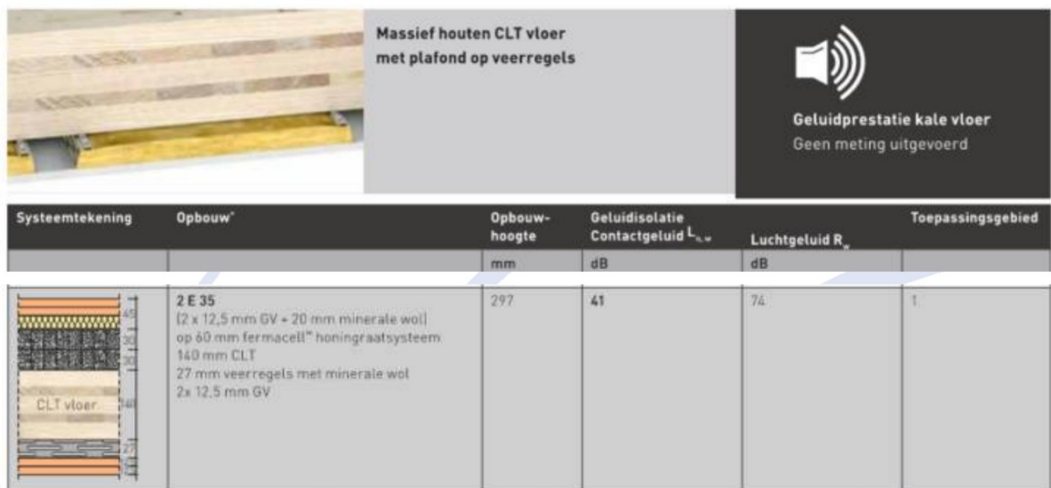
Figuur 3: vergelijkbare opbouw Fermacell constructies versie december 2019
