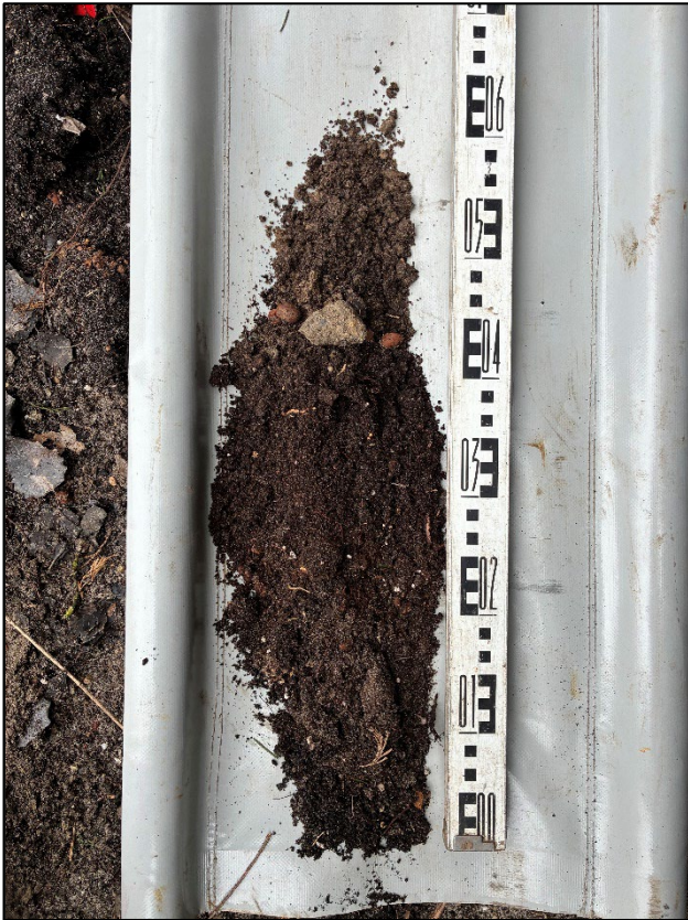
Figuur 14: Opbouw van de grond met op 45 cm – mv een harde storende puinlaag.
