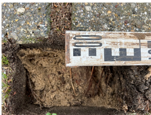
Afbeelding 9. Oppervlakkige wortel doorsnede ca < 10cm onder verharding.
