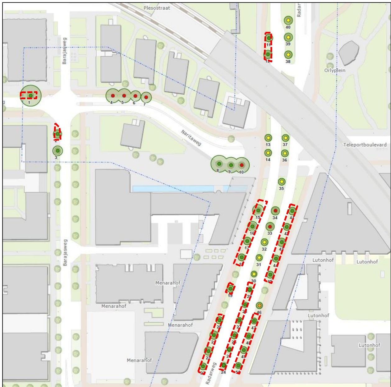
Figuur 9: Af te schermen zones bij te handhaven bomen door middel van gekoppelde bouwhekken, aangegeven met rode lijnen.
