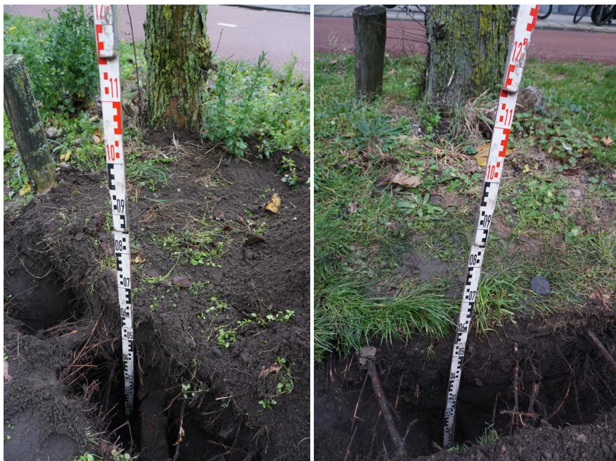
Foto 9 en 10: Proefsleuf bij de fladderiep met boomnummer 13 (links) en 19 (rechts).
