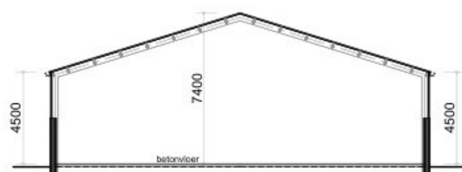
- Doorsnede A - A gebouw 2 -
