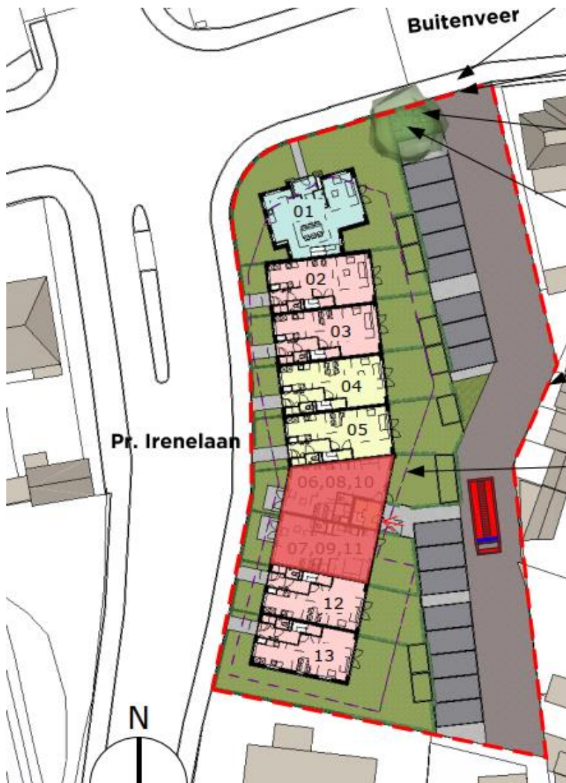
Figuur 2.11.1: Voorgestelde opstelplaatsen brandweervoertuig
