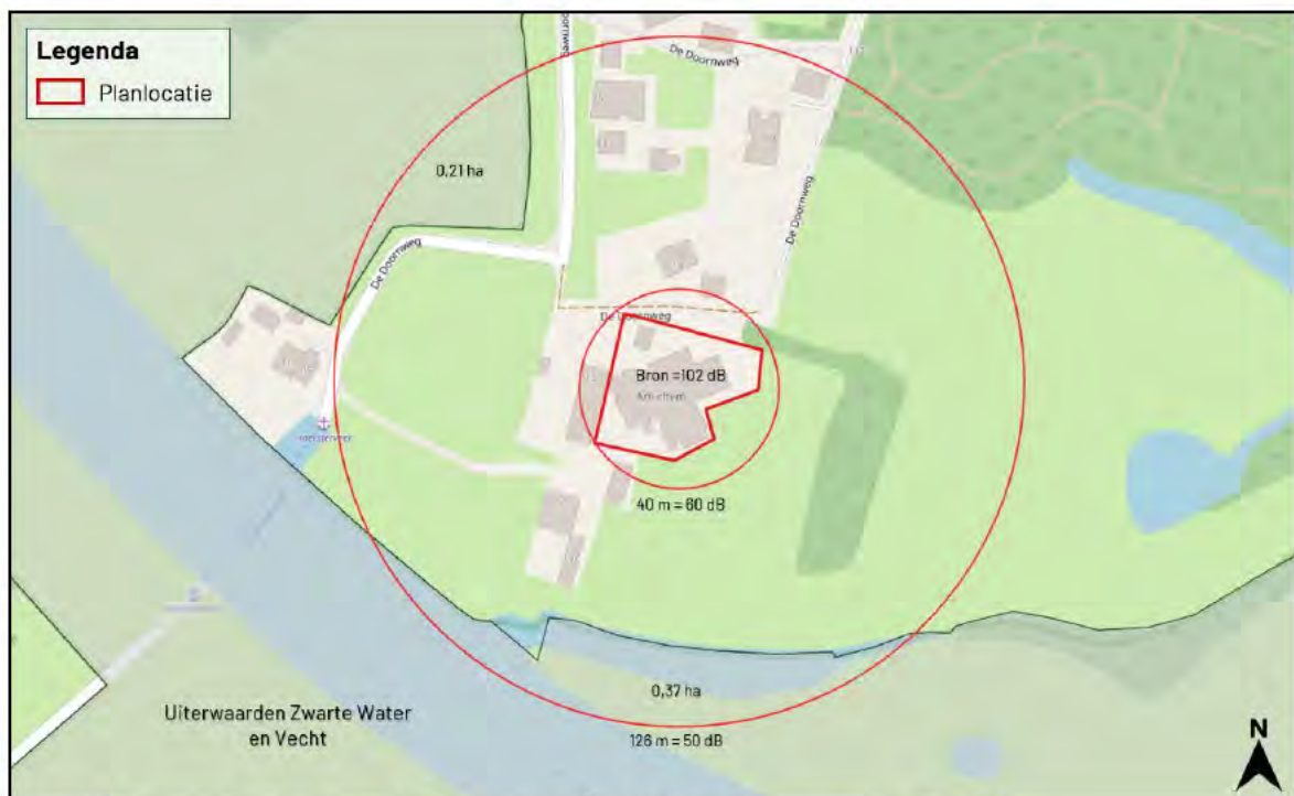
Figuur 3.3 Het piekgeluid van de bouwplaats is op 126 m afgenomen tot 50 dB(a).
