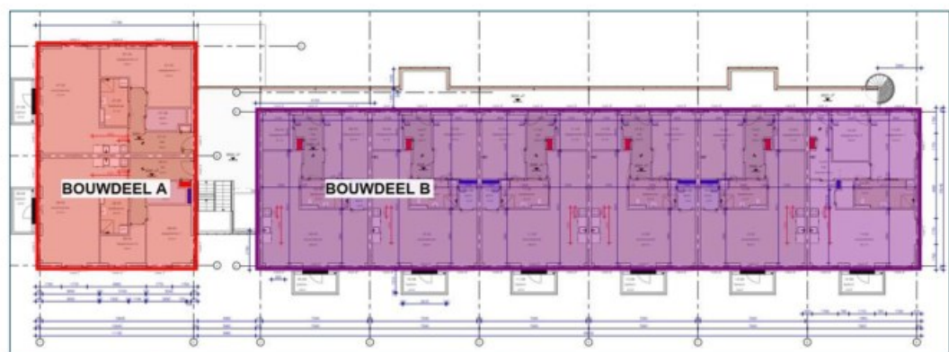
Figuur 3 Situering thermisch schil creëert twee bouwdelen.
