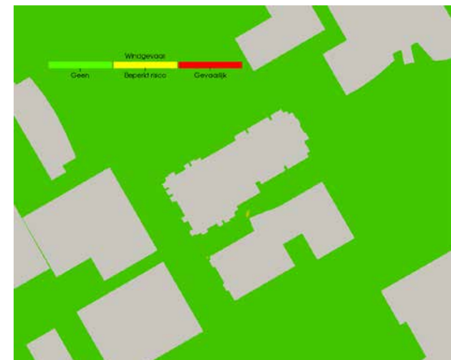
Figuur 6-12. Windgevaar; bestaande bebouwing + PHW 15, 17, 30 en 44.
