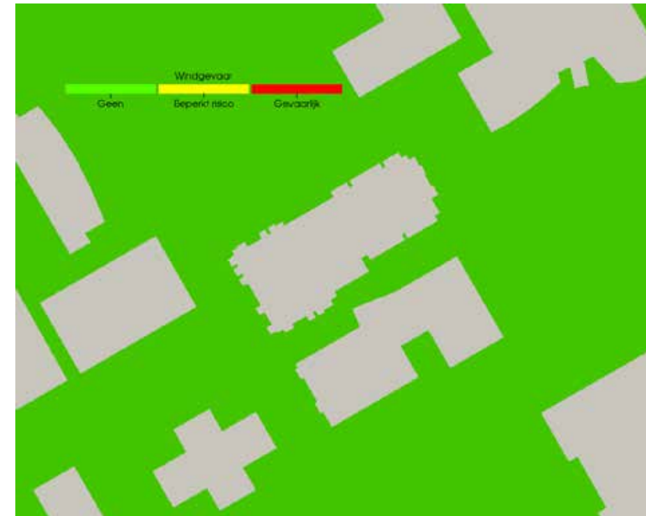
Figuur 6-11. Windgevaar; bestaande bebouwing + PHW 15 en 17.
