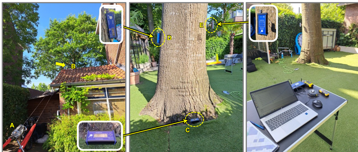
Fig. 2: Tijdens de trekproef is er met een lier (A) met een gecontroleerde kracht van ruim 2.000 kg aan de boom getrokken. Deze kracht wordt gemeten met een digitale trekkrachtmeter die aan de lierkabel is bevestigd (B). Op de stamvoet is een inclinometer bevestigd die het kiepen van de wortelkluit registreert tijdens het trekken aan de boom (C). Een elastometer (D) meet de compressie en rek op de houtvezels van de stambasis zodat schade aan de houtstructuur voorkomen wordt. Een overload-indicator (E) geeft aan wanneer de grenswaarden voor trekkracht, kiepen van de wortelkluit of compressie van de houtvezels is bereikt (midden). Om de mogelijke oorzaak van de vermoedde toenemende scheefstand van de boom te vinden, is met een grondboor een profielboring verricht op ca. 3,5 m ten westen van de boom (rechts). Daarbij is tot 1,2 meter diepte een goed doorwortelbare humeuze teelaarde aangetroffen met daaronder een harde, moeilijk doordringbare bodemlaag.
