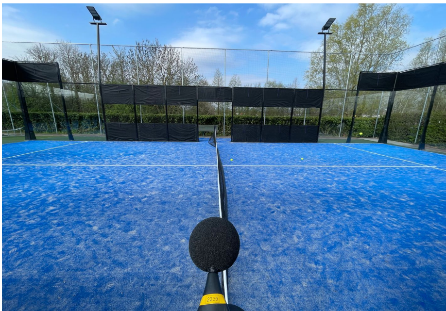
f7 Situatie 3 met 40 geluidsabsorberende panelen
