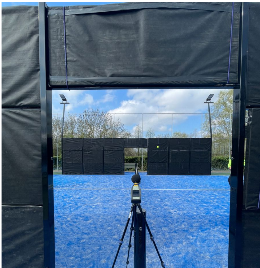
f8 Situatie 4 en 5 met 52 geluidsabsorberende panelen
