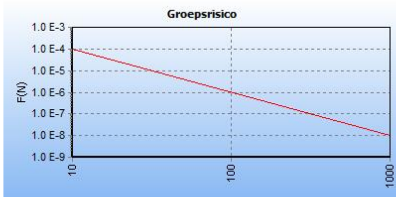
5.9 Figuur 5.9 FN curve voor 9098_leiding-N-557-27-deel-1 van N.V. Nederlandse Gasunie voor de kilometer tussen stationing 680.00 en stationing 1680.00
