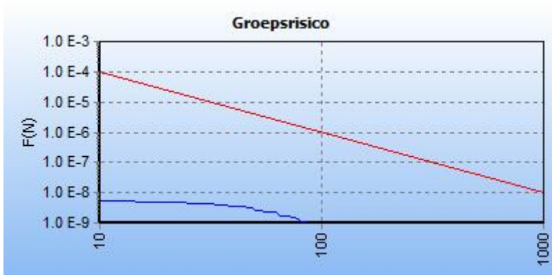
5.5 Figuur 5.5 FN curve voor 9098_leiding-A-549-deel-1 van N.V. Nederlandse Gasunie voor de kilometer tussen stationing 0.00 en stationing 0.00
