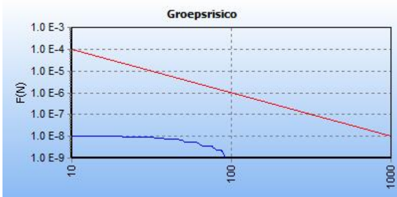
5.4 Figuur 5.4 FN curve voor 9098_leiding-A-522-deel-1 van N.V. Nederlandse Gasunie voor de kilometer tussen stationing 1570.00 en stationing 2570.00
