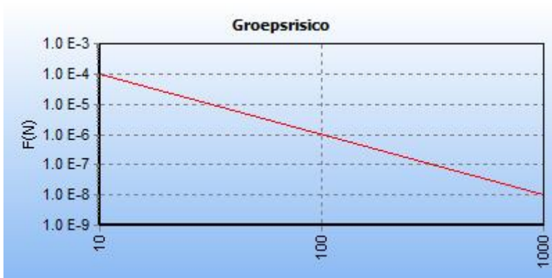
5.8 Figuur 5.8 FN curve voor 9098_leiding-N-557-26-deel-1 van N.V. Nederlandse Gasunie voor de kilometer tussen stationing 0.00 en stationing 1000.00
