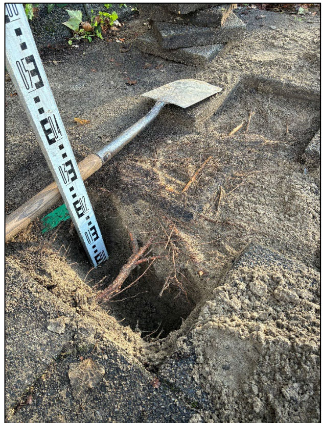
Figuur 10: Profielsleuf nabij boom 53 waarbij opdruk veroorzakende stabiliteit wortels zichtbaar zijn.
