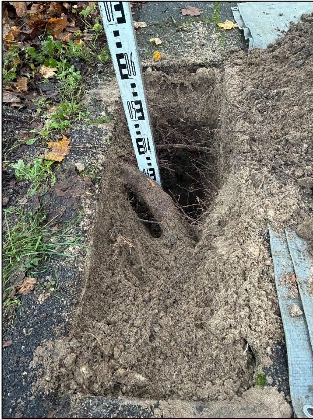
Figuur 19: Zicht op profielsleuf ter hoogte van boom 109 met sterke wortelontwikkeling onder de tegelverharding.
