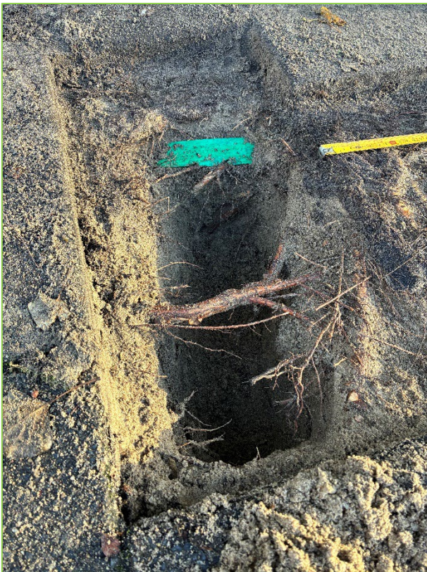
Figuur D: Wortelontwikkeling binnen profielsleuf nabij boom 53.
