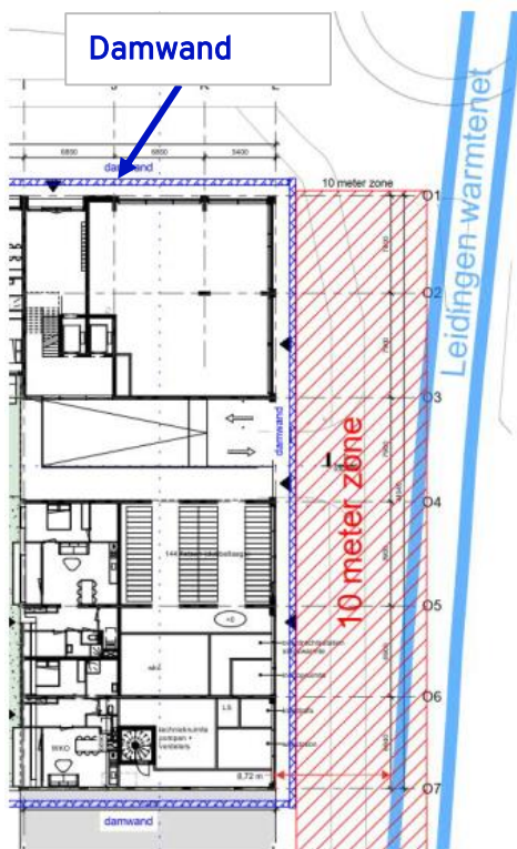
Figuur 4 Ligging leidingen warmtenet t.o.v. bouwkuip [4]
