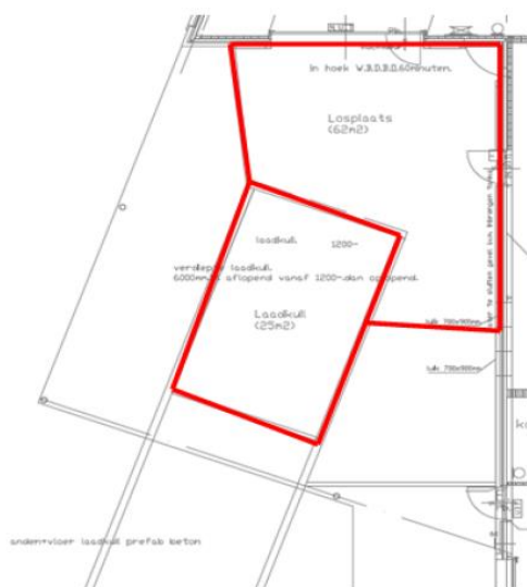
Plattegrond losplaats en laadkuil (87 m 2 )
