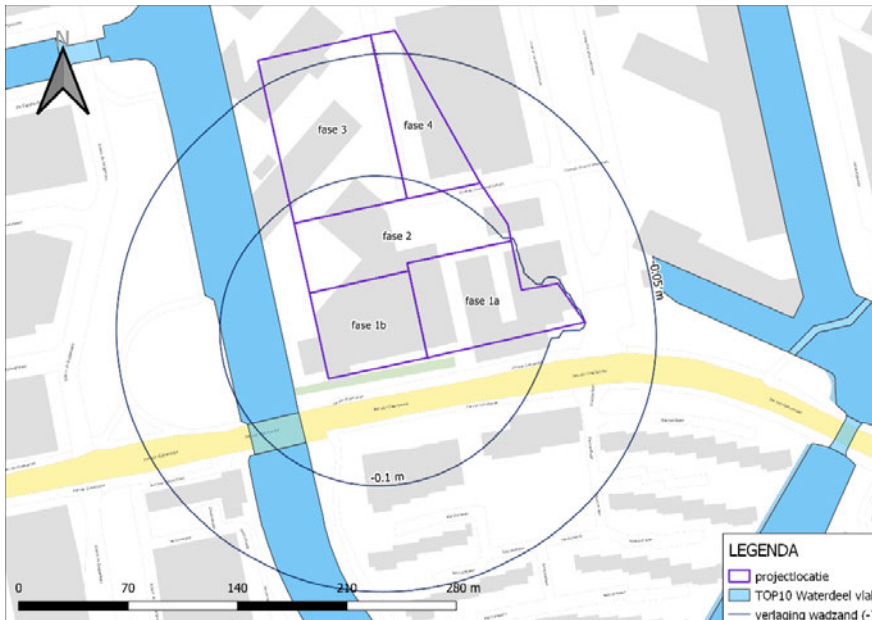
Figuur 4: Stijghoogteverlaging in de wazandlaag
