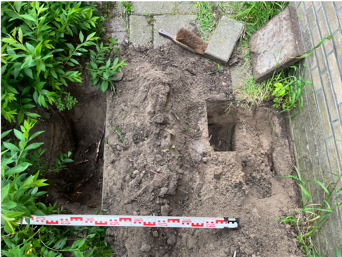
Figuur 14: Beworteling boom 13 tot aan de bebouwing
