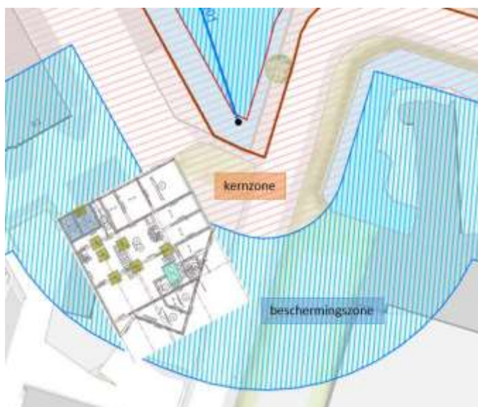
Figuur 3 Nieuwbouw t.o.v. waterkering [4]
