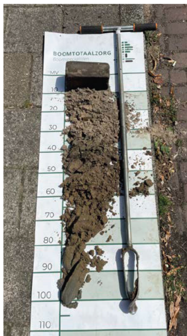
Afbeelding 17: Bodemprofiel Locatie 4, grondwater op -100 cm en reductiezone op -80 cm (onder parkeerparkeervak)
