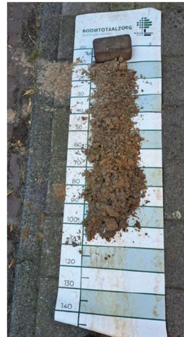
Afbeelding 15: Bodemprofiel locatie 3. Grondwater op -100, reductiezone op -80 cm (onder parkeervak)
