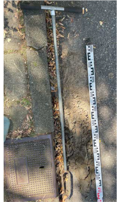
Afbeelding 21: Profielboring. Humusarm zand. Grondwater op -105 cm en reductiezone op -85 cm (onder trottoir)
