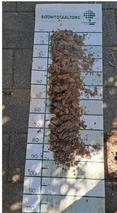
Afbeelding 13: Bodemprofiel locatie 2. Grondwater op -85 cm, reductiezone op -70 cm (onder trottoir)
