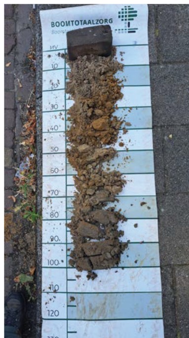
Afbeelding 11: Bodemprofiel locatie 1. Grondwater op -95 cm. Reductiezone op -75 cm (onder parkeervak)
