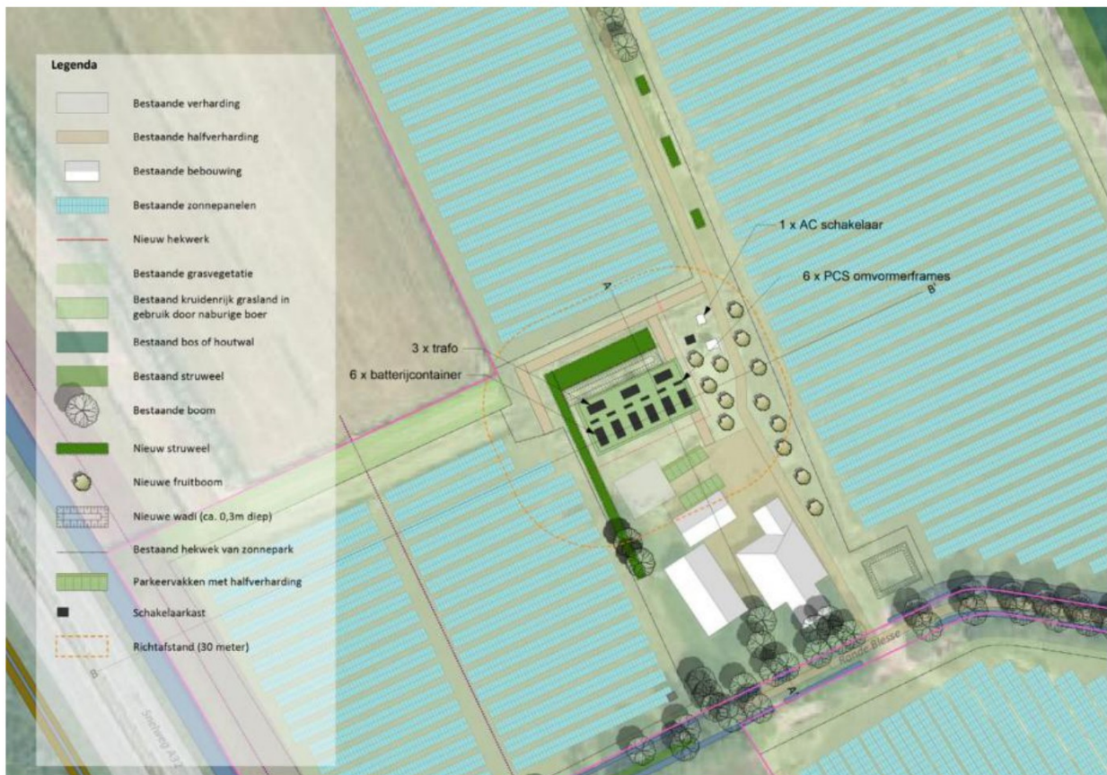
Figuur 8: Inrichtingsschets batterijopslaglocatie
