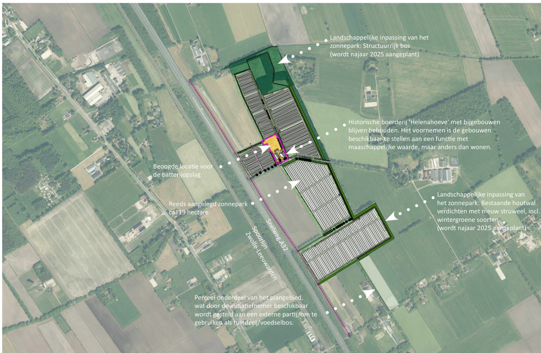
Afbeelding 1. Huidige situatie, 30 hectare grond voor duurzame energie, waarvan in rood 1 hectare voor Batterijopslagsysteem.
