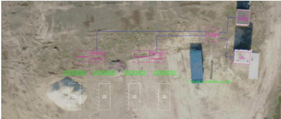
Afbeelding 3. Opstelling batterijopstelling Hauwei; trafo, batterijcontainers, verdelers, PCS frame
